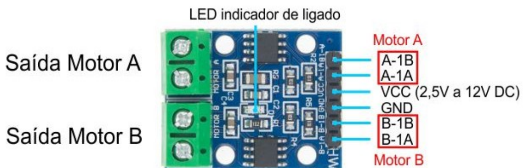
Pinout / Pinos de conexão Driver Duplo Ponte H L9110s
