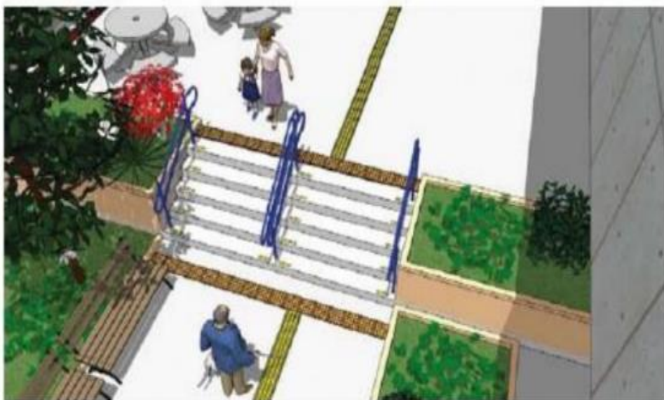
FIGURA 7 - Sinalização de Piso Tátil Alerta em escada. Fonte: ABCP, 2015
