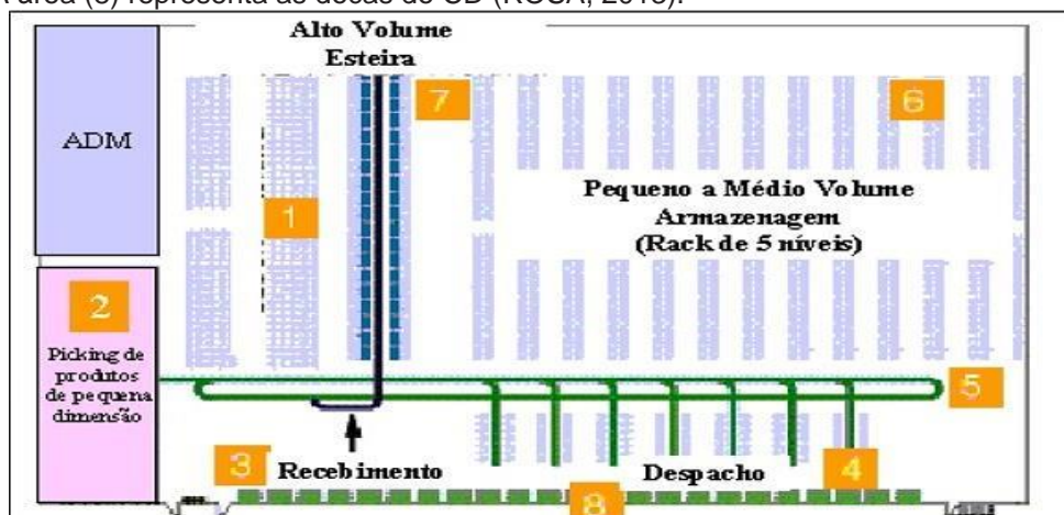
Figura 1 - Leiaute baseado no princípio do giro dos produtos. Fonte: Adaptado de Rodrigues (apud, Rosa, 2013, p. 30).
