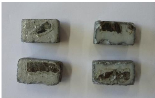
Figura 6 – Registro fotográfico dos CPs de concreto após o ensaio de desgaste. Amostra padrão A (esquerda) e Amostra teste B (direita).
