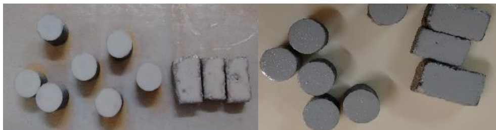
Figura 4 – Corpos de prova com a tinta padrão (esquerda) e tinta teste (direita).
