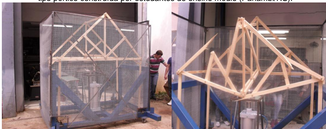
Figura 9 – Fotografia do ensaio mecânico do protótipo em madeira de uma estrutura mecânica tipo pórtico construída por estudantes de ensino médio (Panambi/RS).
