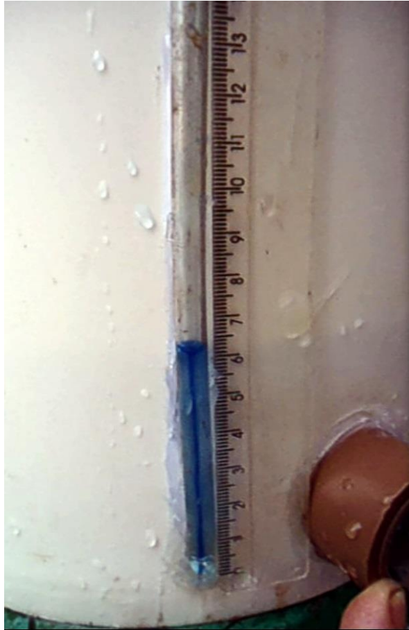
Figura 2: Fotografia do sistema de medição da altura no teste experimental.
