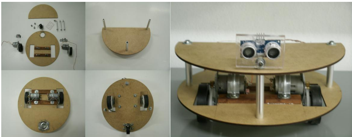
Figura 02: Esquemático: montagem das peças, mecânica e eletromecânica do robô.
