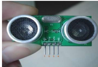
Figura 01: Sensor ultra-sônico – Pinos da esquerda para a direita: 1) 5V - Alimentação; 2) TRIG - Disparo do sinal, um pulso inicia; 3) ECO - Pulso do Eco; 4) GND – Terra
