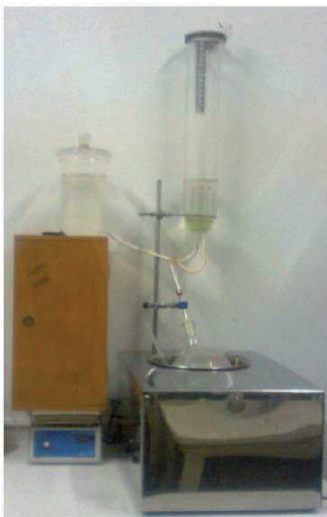
Figura 2.2: Biodigestor utilizado nos testes
