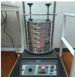
Figura 2: Agitador eletromagnético de peneiras. (Fonte: as Autoras).
