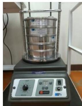
Figura 2. Agitador eletromagnético e peneiras (Fonte: O Autor).
