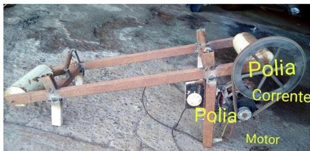
Figura 1: Vista lateral do transportador sem a correia. (Fonte: Os autores)
