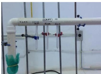
Figura 1. Célula de Arnold para determinação do coeficiente de difusividade mássica (Fonte: os Autores).
