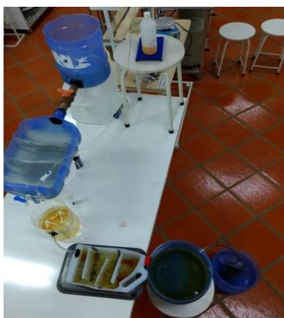
Figura 1: Protótipo da estação de tratamento de água (Fonte: Os Autores).
