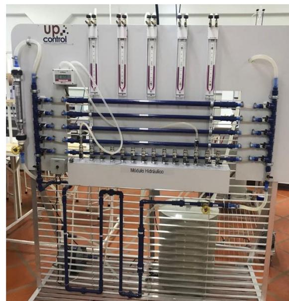
Para medir a vazão utilizou-se um rotâmetro. O controle foi feito com uma válvula globo, que foi mantida com uma vazão constante de 10 L/mim.
