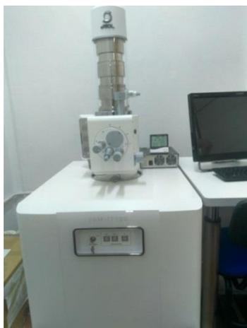
Figura 1: Equipamento de microscopia eletrônica de varredura (Fonte: o Autor).
