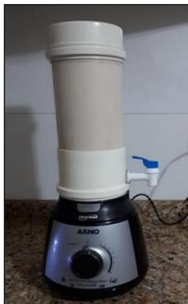
Figura 1. Protótipo da centrífuga (Fonte: os Autores).
