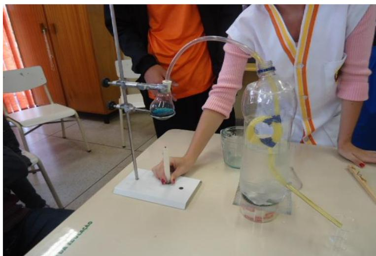
**Figura 5:** Foto do destilador construído no laboratório de aula
